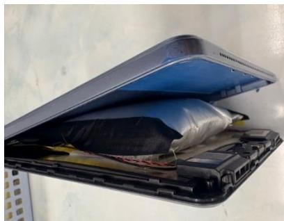
タブレットに内蔵されているリチウムイオン電池が膨らんでしまった事例。
